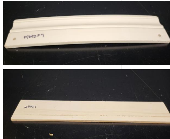
Moulure en pin après une période de mouillage et de séchage
