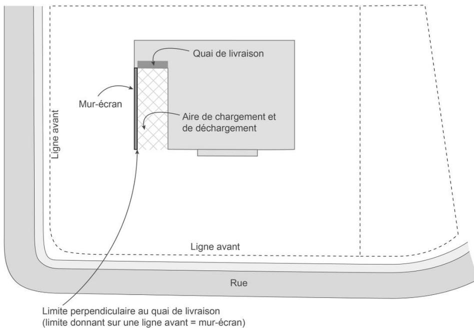
**Figure 11.1 Aire de chargement et de déchargement (exemple en cour avant secondaire dans une zone à dominance commerciale (C))**
