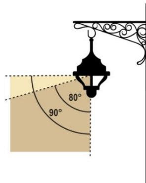
**Figure 12.8**      **Flux lumineux conforme au critère 1)**
